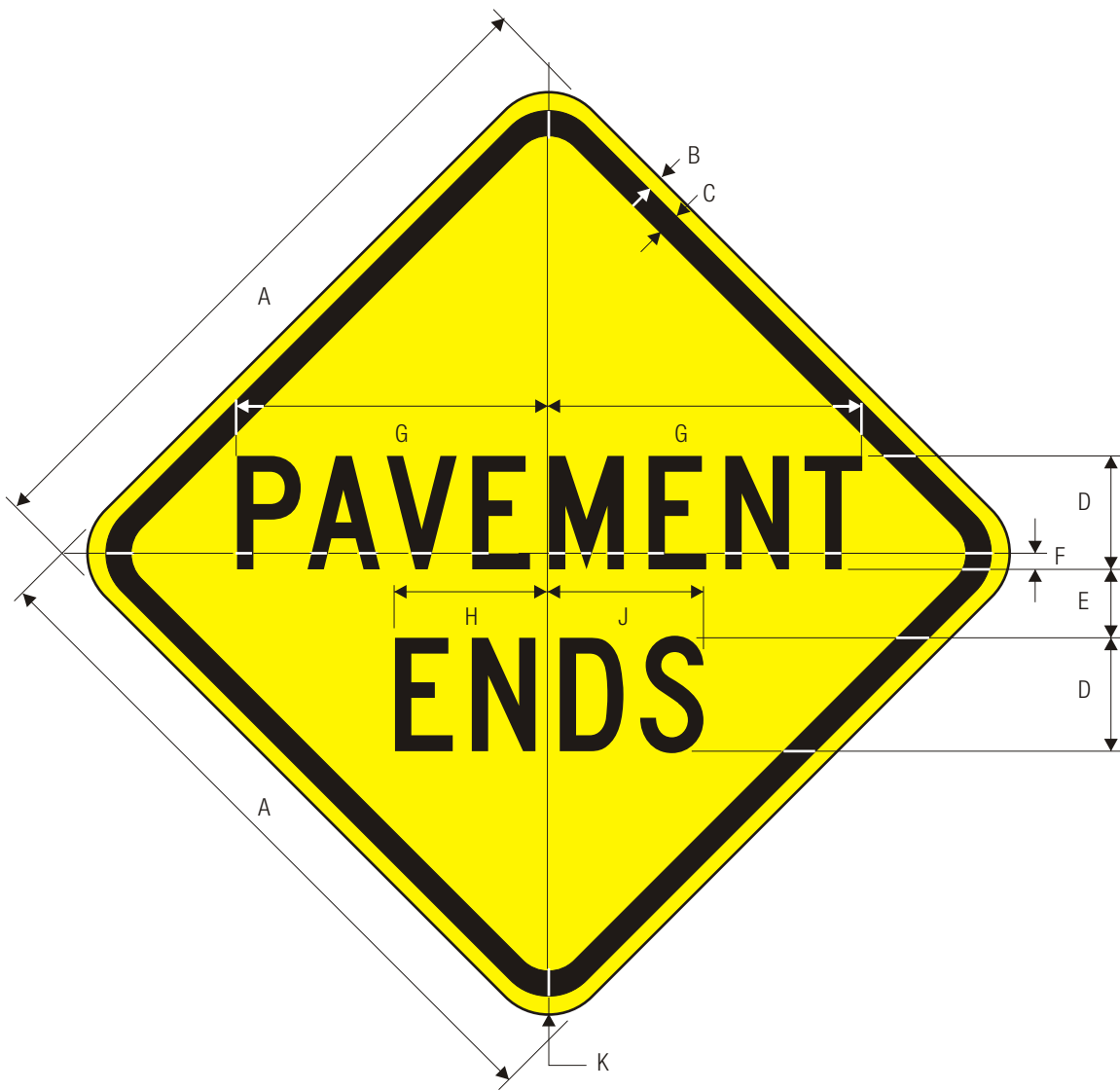
W8-3 PAVEMENT ENDS
